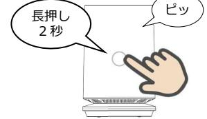
タッチパネル操作部を長押し（約2秒）すると、“ピッ”という音と共に首振り動作します。もう一度長押しすると首振り動作を停止します。
